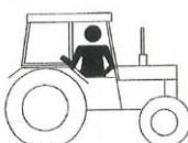
L'opérateur ne doit actionner les leviers de commande de la GR 20 / GR 30 qu'une fois installé dans le tracteur.
