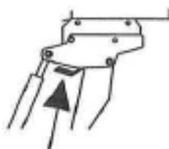
Vérrouiller l'arrimage du GR 20 / GR 30 sur le chargeur
