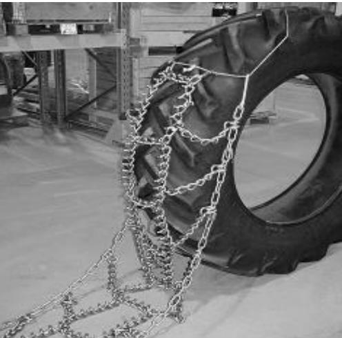
5. Kjettingen legges bak traktoren med piggene opp og låser mot dekket. En snor tres gjennom felgen evt henges fast i dekkets mønster. Kroker og låser festes som vist. Det er viktig at kjettingen kjøres på. Kjettingmønsteret legger seg da riktig i forhold til dekkribbene.
