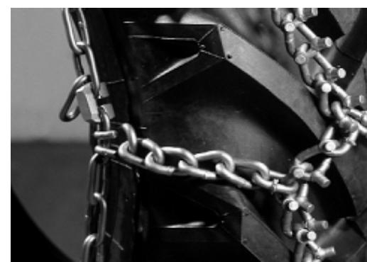
2. Dersom kjettingen skal kortes inn en seksjon iht tabellen, fjernes siste innkortingsledd på sidekjettingen og S-krokene på banen. Skrusjaklene på neste seksjon løses for enklere montering.
